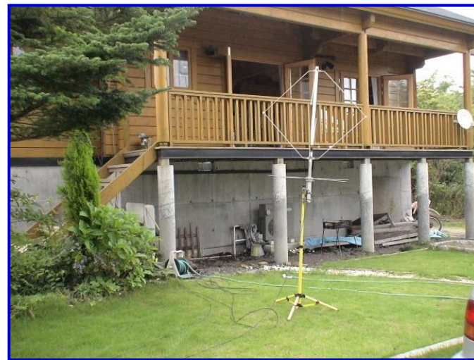
測定点に設置した DX-1Proアンテナ
